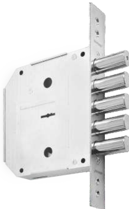
3B8-6КП.5, сувальдного типу, ригелі - 5 шт., d=18 мм, з системою «антиспил», 4 клас вломостійкості
